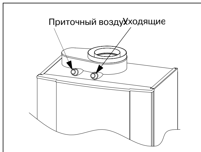
Илл. 14: Точка измерения уходящих газов
