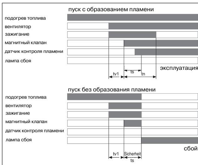
$t_s$  - контрольно-предохранительный период
