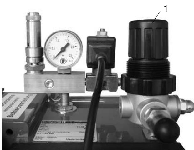
Первичный воздух устанавливается в зависимости от необходимой мощности регулятором давления воздуха (1). Необходимые данные можно определить по ниже приведённому графику. Топливо с большей вязкостью требует более высокое давление воздуха.
