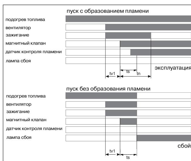
ts - контрольно-предохранительный период
