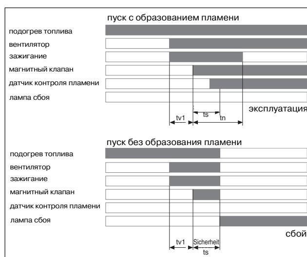
ts - контрольно-предохранительный период
