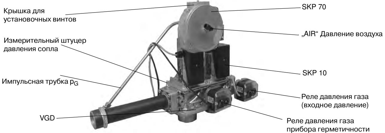
Присоединить голубую трубку „AIR“ газового блока с газовой обоймой горелки. Соединительная трубка должна пролегать в свободном изгибе.
