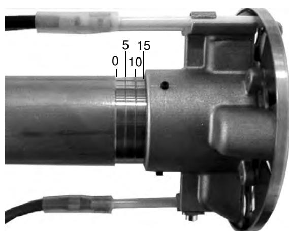
Позиция смесительного устройства зависит от потребной мощности горелки и устанавливается по таблице стр. 14.
