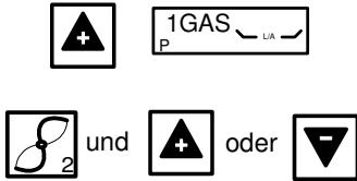
После установки параметров для **P9**, кнопкой **Плюс** выбрать **P1** - на дисплее высветится **1GAS**. Удерживая нажатой кнопку **2**, другой рукой нажатием кнопок **Плюс** или **Минус** можно задать значение мин. мощности от 0° до 90°. Установочные параметры Вы можете взять из таблицы предварительной настройки.
