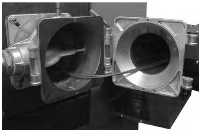
Вставьте корпус горелки в шарнир газовой обоймы и закрепите его при помощи крепёжного стержня. Горелка находится при этом в сервисном положении.
