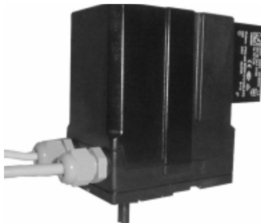
Сервопривод воздушной заслонки служит для установки воздушной заслонки у горелок с воздушным затвором. Установки задаются через электронный блок управления.
