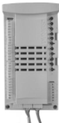
МРА топочный автомат с микропроцессорным управлением± сервопривода для контроля и управления пневмо модулирующей горелкой и с интегрированным прибором контроля герметичности клапанов Топочный автомат МРА оснащён шиной передачи данных **BUS**. При непрерывной работе в течении 24 часов блок управления МРА 22 выключает горелку на короткое время (20-30 сек.) для проверки всех установок, включая проверку герметичности клапанов.
