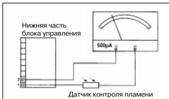
При отклонении стрелки прибора в обратную сторону следует поменять местами концы подключения измерительных проводов!
