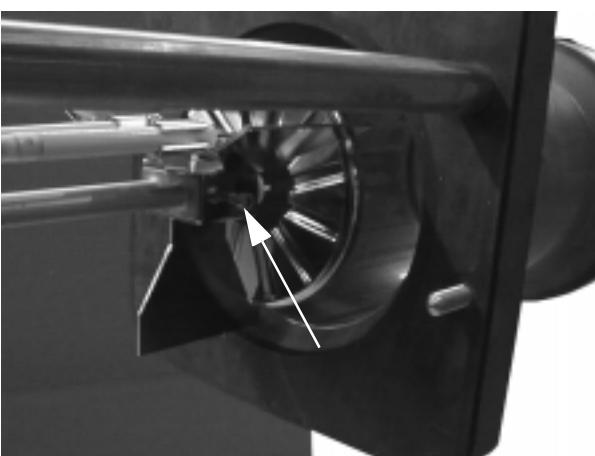
Выбранные форсунки ввинтить при помощи шестигранного ключа (SW16) . Вильчатый гаечный ключ следует использовать как к контролпору .Затем вплотную снова насаживается подпорный диск и затягивается до упора.
