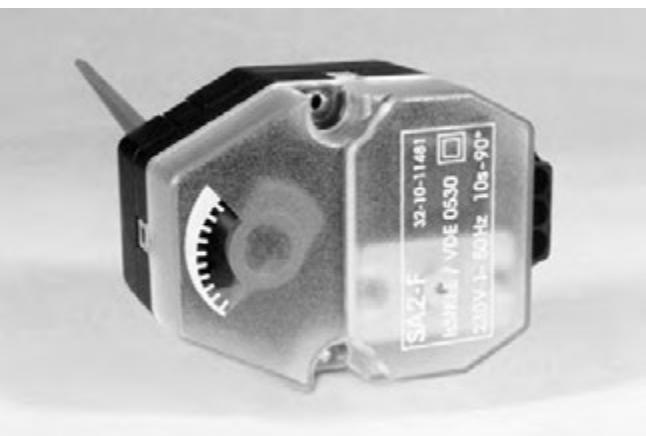
У горелок в исполнении -L воздушная заслонка препятствует охлаждению топочной камеры при перерывах в работе установки. Управление воздушной заслонкой-электрическое. Перед пуском горелки воздушная заслонка открывается. Её положение можно определить по указателю на сервоприводе. Показание положения „ОТКР“-„ЗАКР“. В случае технического обслуживания или нительного оснащения обратить внимание на схему электрических соединений стр. 22-26 .
