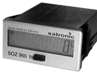
Этот многофункциональный прибор даёт информацию о расходе топлива, количестве пусков горелки, часах ее работы и т.д., а кроме того сигнализирует, если расход топлива опускается ниже установленного номинального значения (напр., засорена форсунка). Благодаря раннему выявлению и устранению дефекта можно предотвратить неэкономичную и экологически вредную эксплуатацию горелки. В ходе эксплуатации необходимо следить за тем, чтобы расход топлива, давление и температура находились в допустимых пределах.
